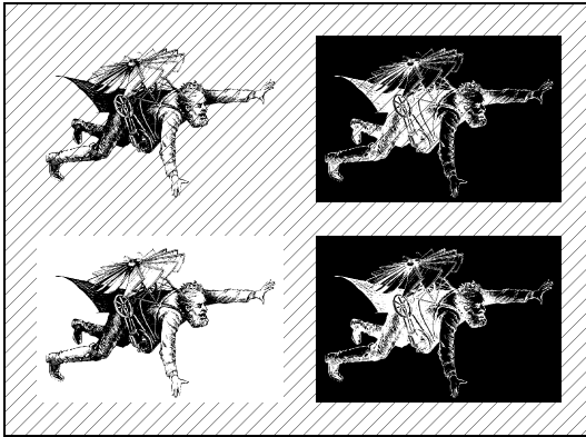
Rys. 3. Te same dane mogą być interpretowane w różny sposób. W przypadku dwubarwnych map bitowych możliwych kombinacji jest – jak widać – co najmniej cztery: (1) rysunek czarny, tło przezroczyste; (2) rysunek przezroczysty, tło czarne; (3) rysunek czarny, tło białe; (4) rysunek białe, tło czarne. W istocie warianty (3) i (4) to szczególne przypadki sytuacji, w której i rysunkowi, i tłu nadawany jest wybrany kolor; w przypadkach (1) i (2) można także wybrać inny kolor niż czarny.
