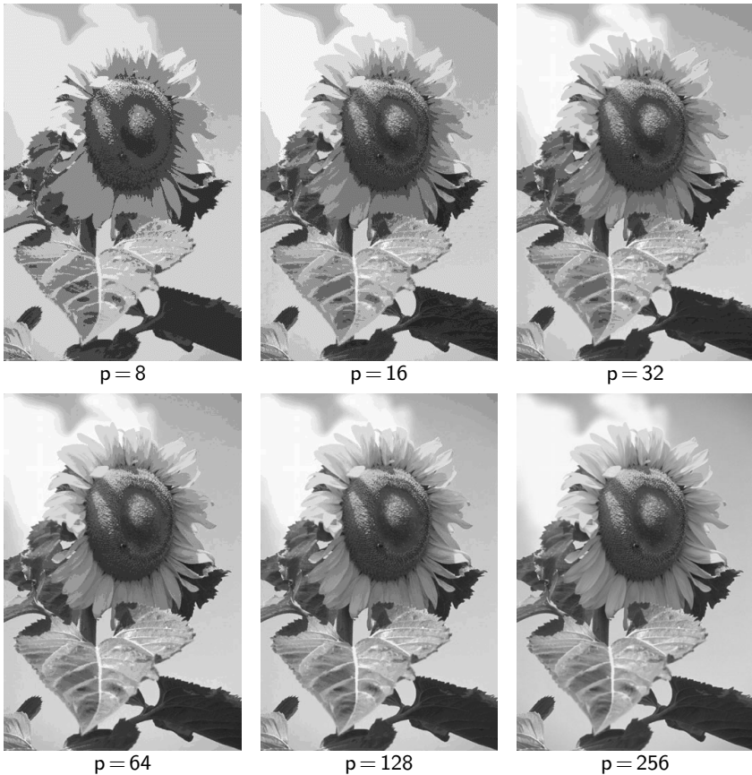
Rys. 6. Porównanie tej samej ilustracji, przygotowanej z użyciem p = 8, 16, 32, 64, 128 oraz 256 kolorów, pokazujące, że pogorszenie jakości może być praktycznie niezauważalne przy umiarkowanej redukcji palety.
